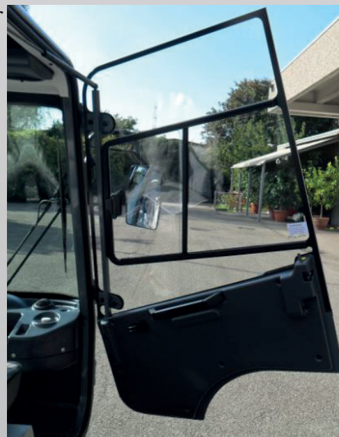
Dörrar med skjutfönster
